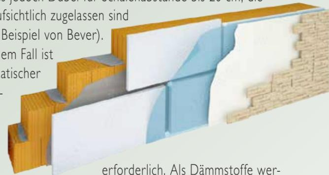
erforderlich. Als Dämmstoffe werden meist eingesetzt: wasserabweisende Mineralfaserplatten, Polyurethanplatten, Polystyrolplatten.
