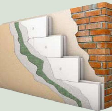
WDVS lassen sich auch mit ökologischen Materialien wie z.B. mit Holzfasern realisieren. Die Dämmung wird dabei mit einem Spezialmörtel direkt auf die Außenwand geklebt. Bei korrekter Bauausführung sind holzfasergedämmte Konstruktionen auch im Brandfall.
